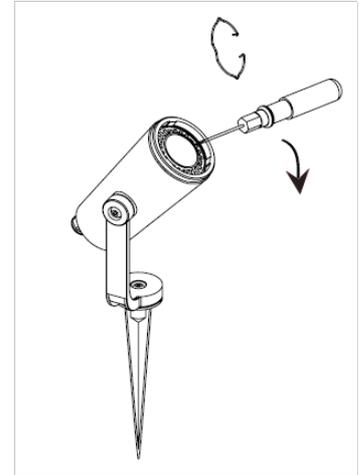
Per la sostituzione della lampada, togliere la molla e con l'aiuto di un cacciavite sollevare la lampada.
