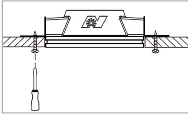
4 - Mettere il corpo in gesso nel foro e fissare con le viti
