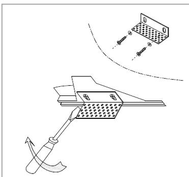
3 - Regolare l'altezza della staffa in base allo spessore del soffitto - dimensione variabile da 6 a 15mm
