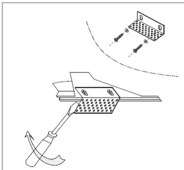
3 - Regolare l'altezza della staffa in base allo spessore del soffitto - dimensione variabile da 6 a 15mm
