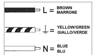
MORSETTIERA NON INCLUSA, L'INSTALLAZIONE RICHIEDE L'AUTO DI PERSONALE QUALIFICATO; MORSETTIERE CONFORME A EN 60998-2-1, PER CAVI SEZIONE DA 0.75mm<sup>2</sup> A 2mm<sup>2</sup>. LA MORSETTIERA DEVE ESSERE INSTALLATA IN UNA SCATOLA, GARANTENDO LA CLASSIFICAZIONE IP SECONDO LE NORME DI CABLAGGIO.
