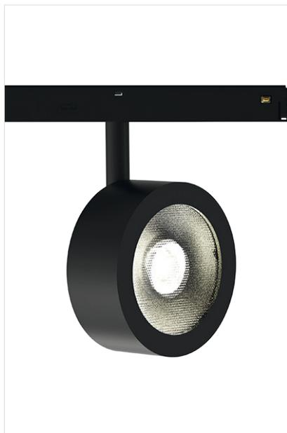
Proiettore LED orientabile per binario a 48V, fascio di apertura 40°, selettore per la temperatura colore da 2700-3000-4000K, potenza 7W, dimmerabile.
