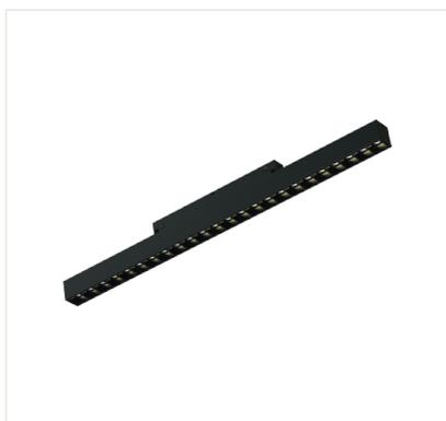
Profilo LED lineare per binario a 48V con ottiche UGR, selettore per la temperatura colore da 2700-3000-4000K, potenza 25W, dimmerabile. LED SMD Lifetime 50.000h (L80B50)
