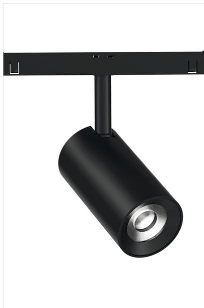
Proiettore LED per binario a 48V, fascio di apertura 40°, selettore per la temperatura colore da 2700-3000-4000K, potenza 15W, dimmerabile. Cover nero opaco intercambiabile. LED COB Lifetime 50.000h (L80B50).
