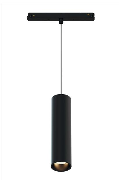
Sospensione cilindrica LED per binario a 48V, fascio di apertura 40°, selettore per la temperatura colore da 2700-3000-4000K, potenza 20W, dimmerabile.
