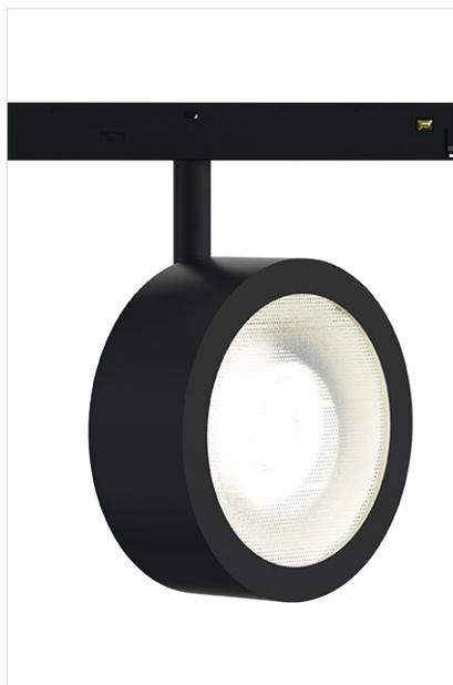
Proiettore LED orientabile per binario a 48V, fascio di apertura 36°, selettore per la temperatura colore da 2700-3000-4000K, potenza 15W, dimmerabile.
