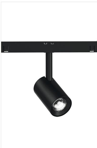
Mini proiettore LED per binario a 48V, fascio di apertura 40°, selettore per la temperatura colore da 2700-3000-4000K, potenza 7W, dimmerabile. Cover nero opaco intercambiabile. LED COB Lifetime 50.000h (L80B50).
